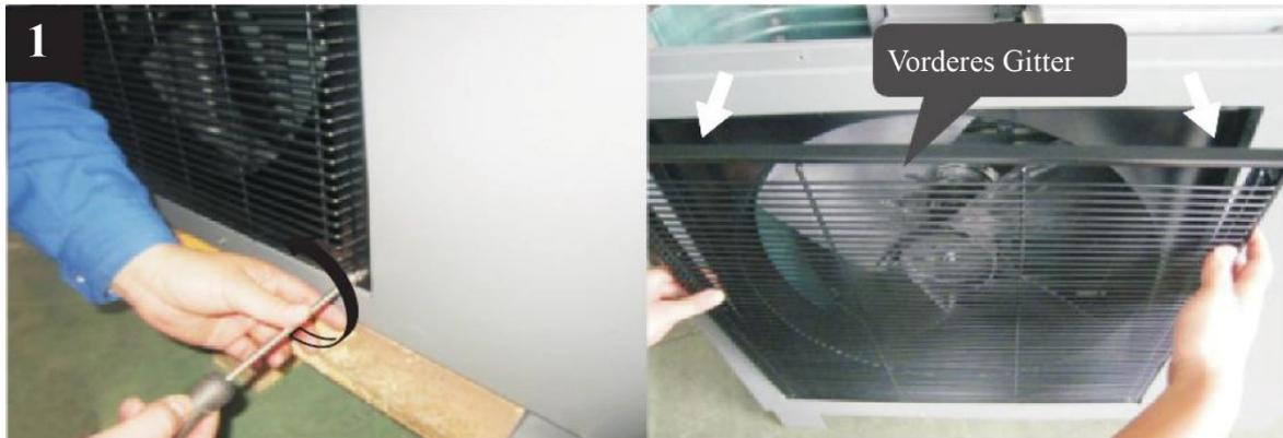
1. Trennen Sie die Stromversorgung, entfernen Sie die Schrauben des Frontgitters.
