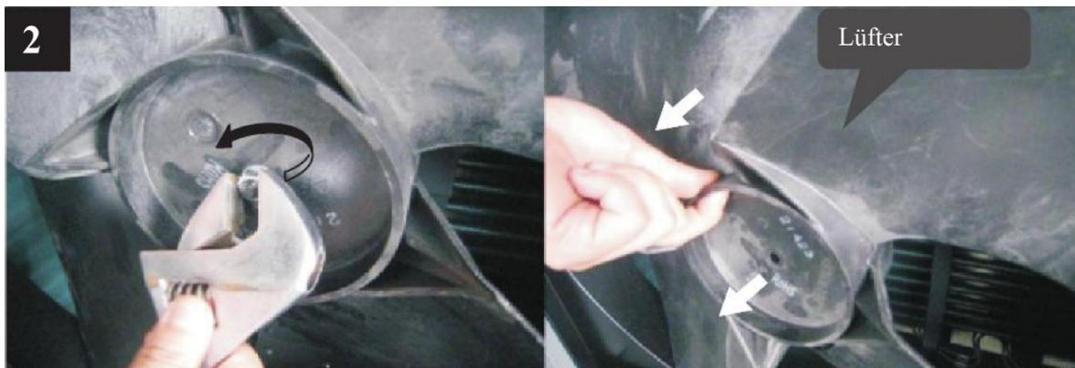
2. Lösen Sie mit einem Schraubenschlüssel die Mutter für den Ventilator und nehmen Sie den Ventilator heraus.
