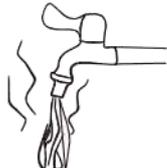
Im Warmwasserkreis bitte immer ein Mischventil vor dem Wasserhahn einbauen und stellen Sie es auf die richtige Temperatur ein.
