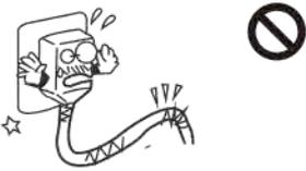
Wenn das Netzkabel beschädigt ist, muss es durch elektrotechnisch qualifiziertes Fachpersonal und unter Beachtung der gültigen elektrotechnischen Richtlinien ersetzt werden.
