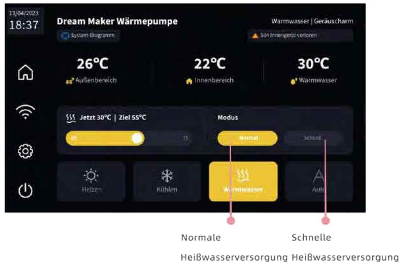
Im Betrieb der Heißwasserversorgung kann der Benutzer einstellen, ob die Funktion der schnellen Heißwasserversorgung eingeschaltet werden soll.
