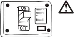
Es ist zwingend erforderlich, einen geeigneten Schutzschalter für die Wärmepumpe zu verwenden und sicherzustellen, dass die Stromversorgung des Geräts den Spezifikationen entspricht.
